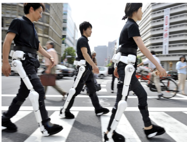
Рис. 1. Экзоскелет HAL (Hybrid Assistive Limb)
