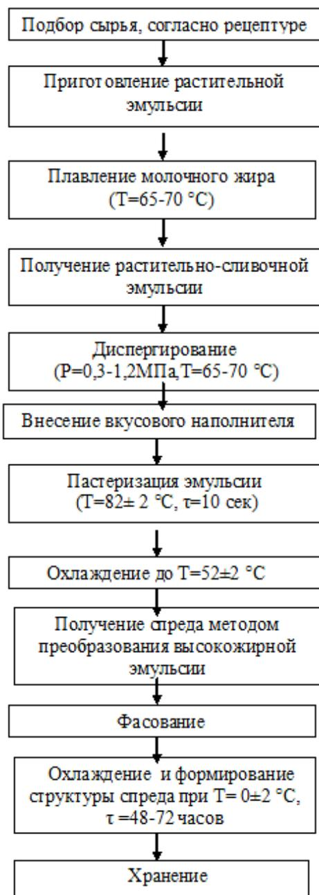
**Рис. 1.** Технологическая схема производства спреда «Клюквенный»
