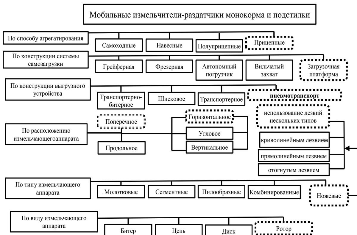
**Рис. 1. Схема классификации мобильных измельчителей-раздатчиков грубых кормов и подстилки**
