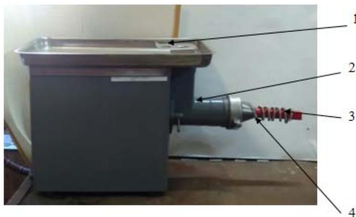
**Рис. 2. Экспериментальная установка для приготовления брикетов из подстильного навоза:**
