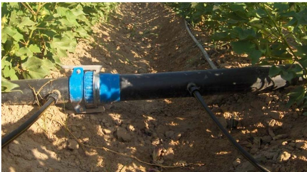
**Рис. 1. Распределительная система капельного орошения**
