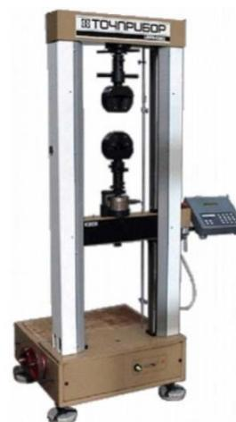
**Рис. 3. Общий вид разрывной машины ИРТ-50**
