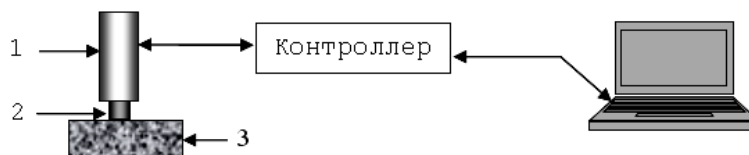
Рис. 1. Измерительная установка «ТЕПЛО-ТЕСТ»:
