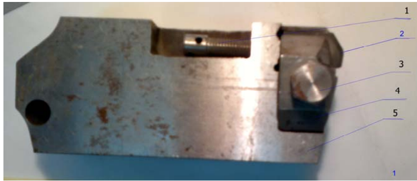
Рис. 3. Конструкция резца с регулируемым вылетом режущей пластины: 1 – винт для регулировки вылета режущей пластины; 2 – режущая пластина; 3 – винт прижима; 4 – прижимная планка; 5 – корпус резца
