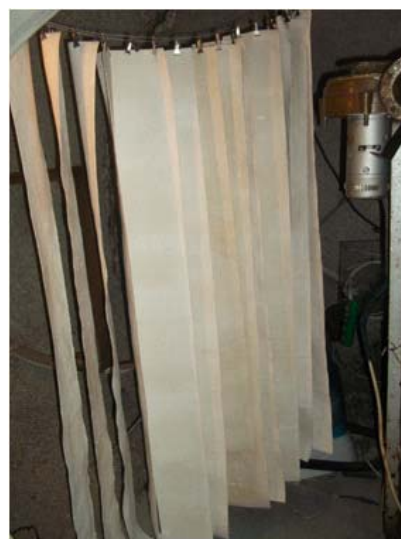
Рис. 2. Размещение листового известкового химического поглотителя в камере для испытаний
