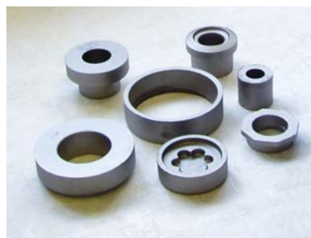
Рис. 2. Фотография поковок полученных бесподпорной штамповкой
